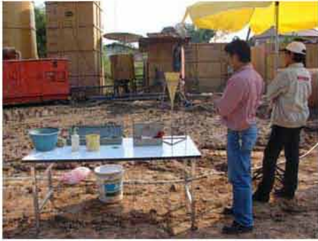
ตรวจสอบคุณสมบัติสารละลายเบนโทไนท์
