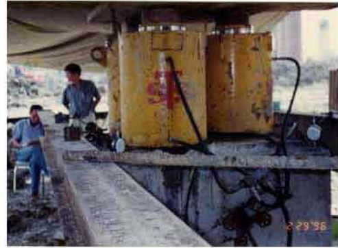
ทดสอบการรับน้ำหนักของเสาเข็มโดยวิธี สถิตยศาสตร์ มยผ.๑๒๕๑
