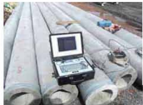
อุปกรณ์ตรวจวัดการทดสอบ Dynamic Load
