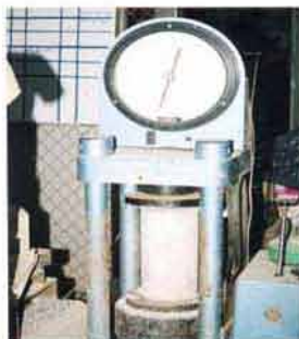
เครื่องทดสอบก้อนคอนกรีต
